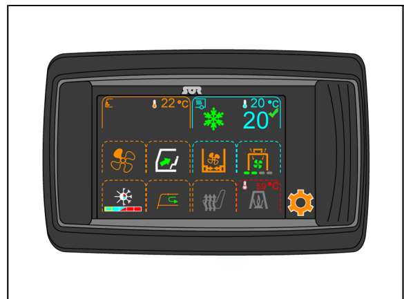
Obrázek 4.42 Dotykový displej pro ovládání topení, větrání a klimatizace
