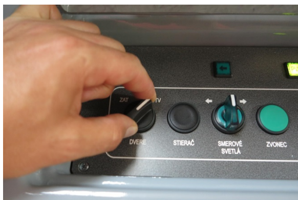
Obr. 99 Otvorenie 4. dverí vozidla zo zadného stanovišta
