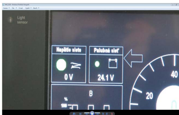
Zasunutý pantograf, palubné napätie bez dobíjania.
