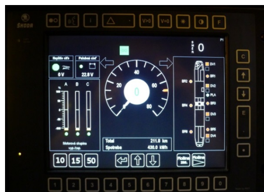
Obr.13 Zapnutá pozičné svetlá (signalizácia "zatvor vlak" nemá s pozičnými svetlami nič spoločné)
