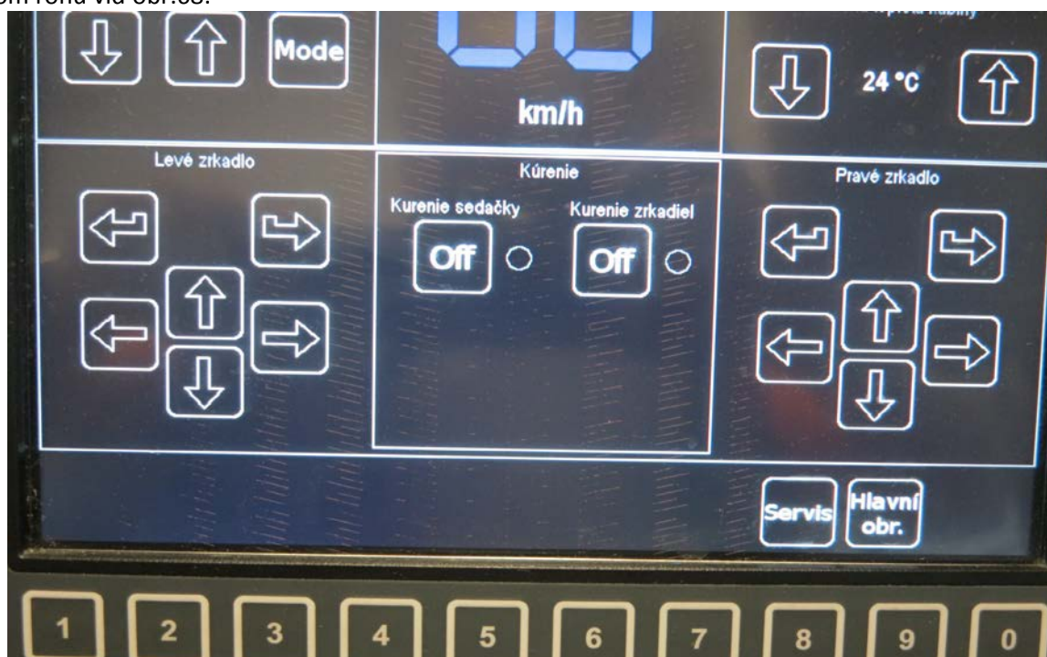
Obr.68 Virtuálne tlačidlá pre ovládanie zrkadiel
