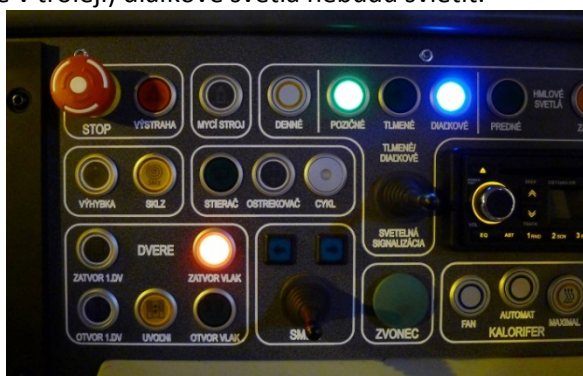
Obr.15 Zapnuté diaľkové svetlá (signalizácia „zatvor vlak“ nemá s diaľkovými svetly nič spoločné)
