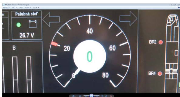
Ručičkový rýchlomer, maximálna rýchlosť 20km/h pre smer jazdy vzad.
