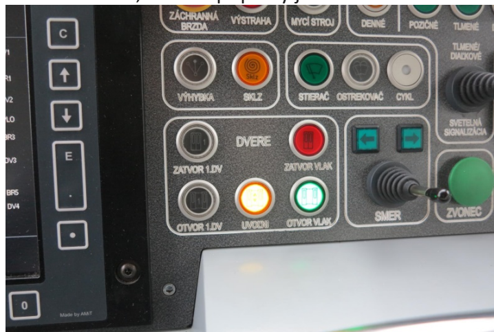
Obr. D2 Funkciu prípravy uvoľnenie všetkých dverí možné aktivovať tlačidlom "UVOLNI" iba za jazdy
