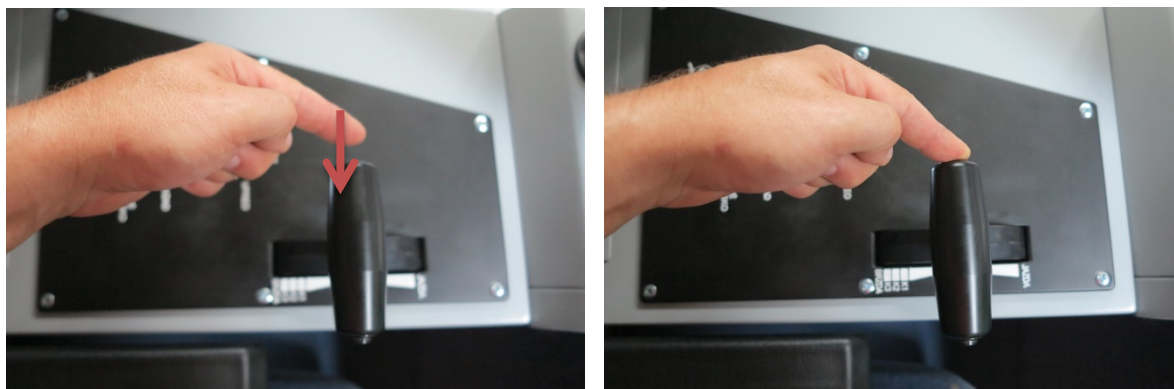
Obr. 108 Vyklopenie páky k vodičovi pre odbrzdenie
