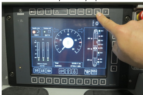
Obr.83 Voľba medzi čiernym a bielym pozadím
