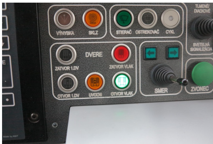
Obr. D1 Funkciu prípravy otvorenia všetkých dverí možné aktivovať tlačidlom "OTVOR VLAK" iba za jazdy.
