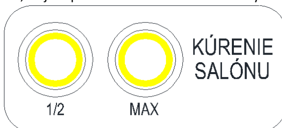
Obr.36 Tlačidlá ovládania kúrenia salónu cestujúcich
