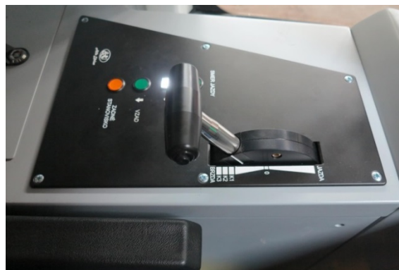
Obr. 105 Poloha radiče pre jazdu a pre prevádzkovú brzdú
