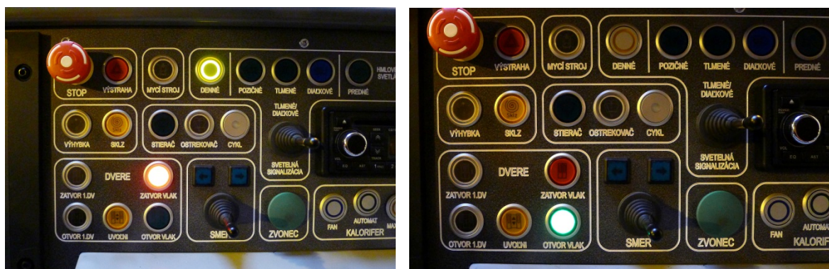
Obr.24 Signalizácia otvorených a zatvorených dverí v tlačidlách
