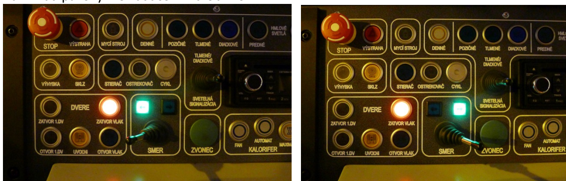
Obr.26 Ovládač a signalizácia smerových svetiel
