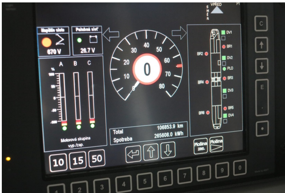
Obr. B1 Zobrazenie použitia koľajnicových bŕzd postupne od 3. podvozku po 1. podvozok
