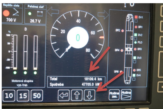
Základné info z tachografu, ovládacie tlačidlá
