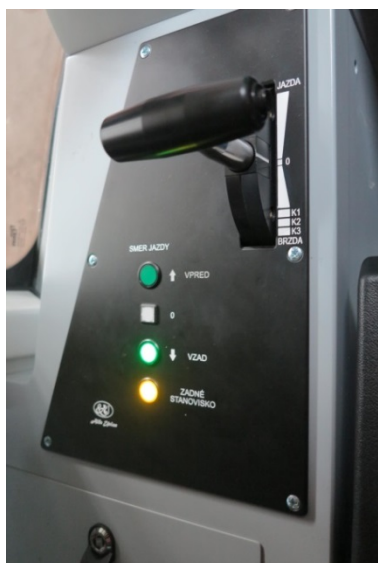
Obr. 104 Voľba jazdy zo zadného stanovište
