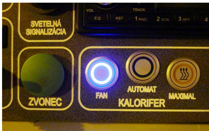
Obr.30 Aktívny režim FAN kaloriferu
