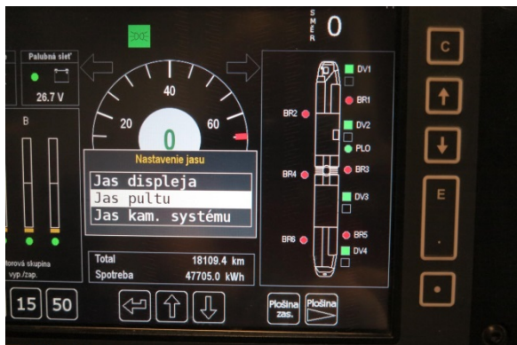
Výber riadenia jasu signáliek a osvetlenie pultu
