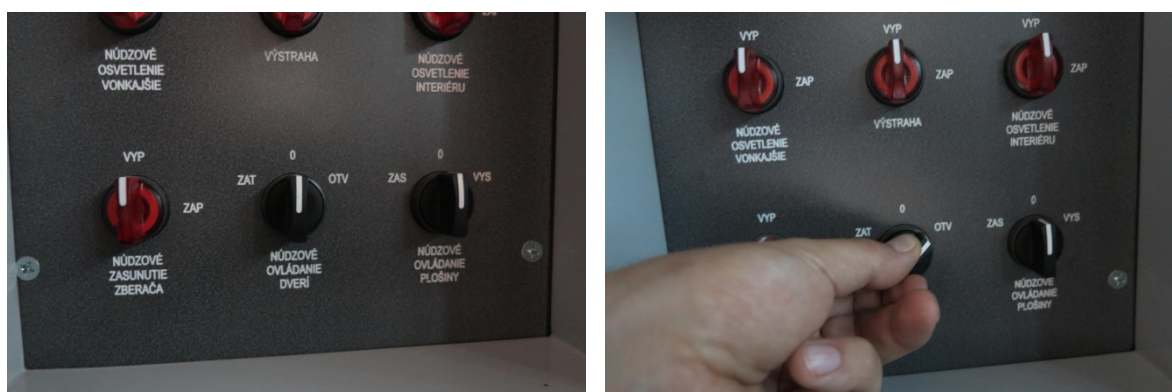
Obr. 96 Núdzové ovládanie dverí
