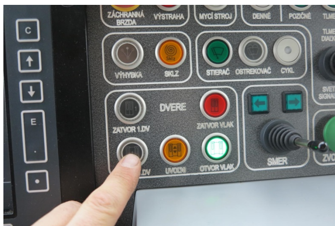
Obr. D3 Funkciu prípravy otvorenia 1. dverí možno aktivovať tlačidlom "OTVOR 1.DV" iba za jazdy.
