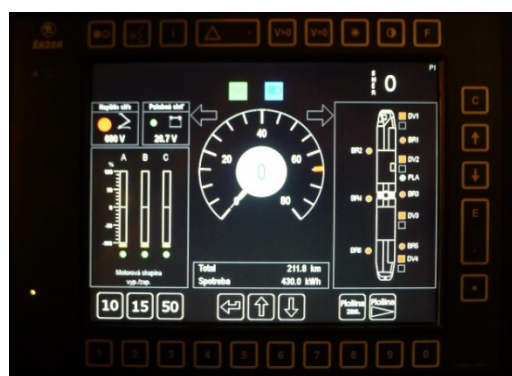
Obr.15 Zapnuté diaľkové svetlá (signalizácia „zatvor vlak“ nemá s diaľkovými svetly nič spoločné)
