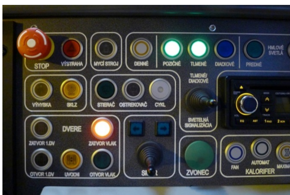
Obr.14 Zapnuté tlmené svetlá (signalizácia „zatvor vlak“ nemá s tlmenými svetly nič spoločné)
