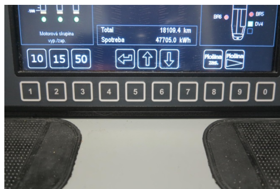
Mechanické tlačidlá pod displejom
