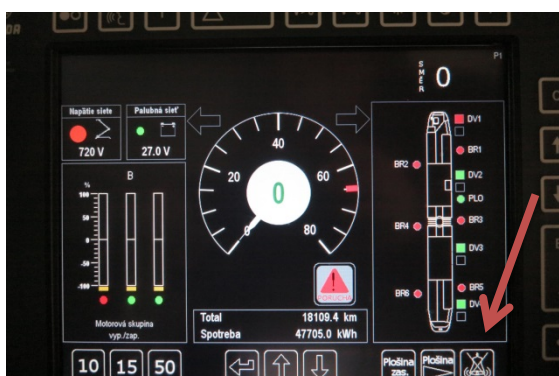
Objavila sa porucha aj s akustickou signalizáciou
