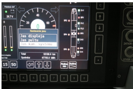
Výber riadenia jasu displeja kamerového systému
