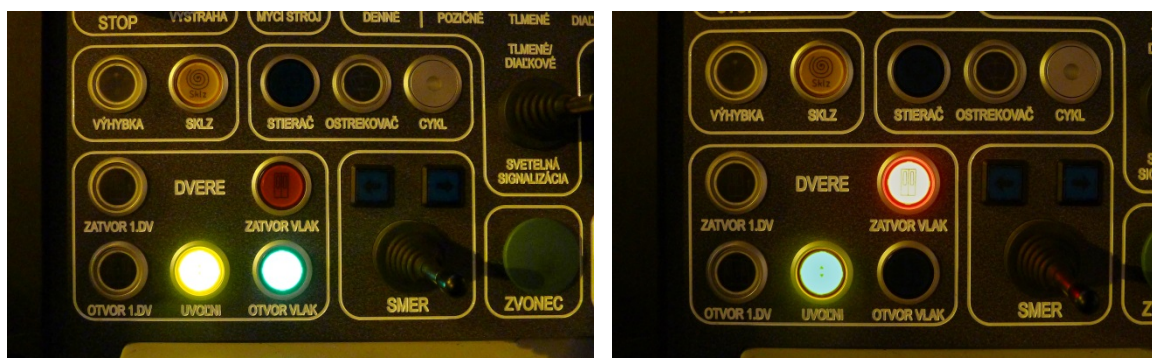
Obr.25 Požiadavka na uvoľnenie - ľavý obr., Režim uvoľnenia - pravý obr.
