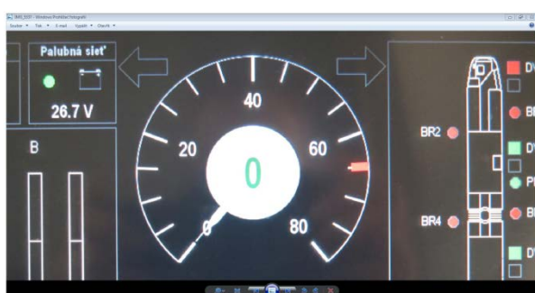
Ručičkový rýchlomer, maximálna rýchlosť 65km/h pre smer jazdy vpred.
