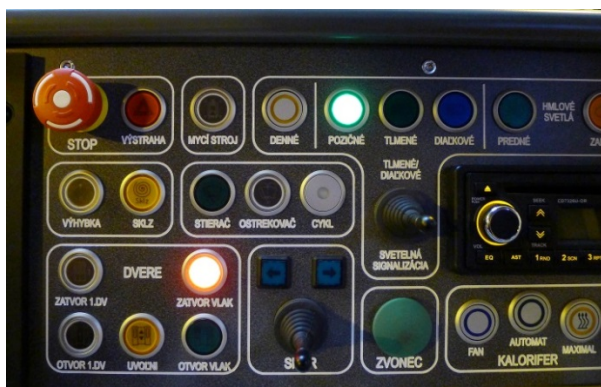
Obr.13 Zapnutá pozičné svetlá (signalizácia "zatvor vlak" nemá s pozičnými svetlami nič spoločné)
