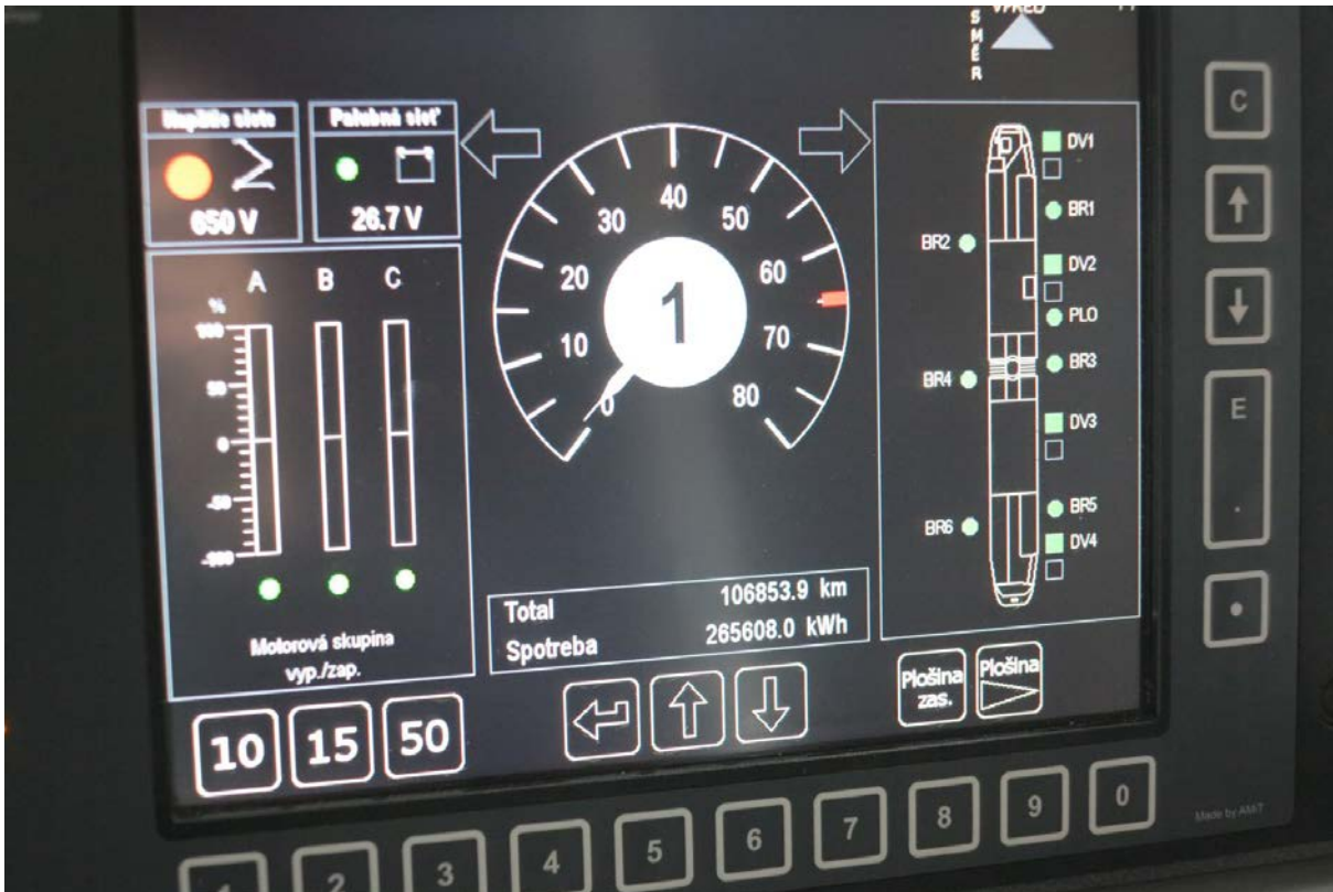
Obr. A2 Základná obrazovka po odbrzdzeniu vozidlá
