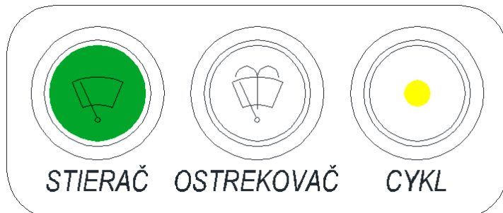
Obr.22 Tlačidlá pre ovládanie stierača a ostrekovača
