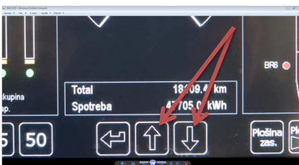
Virtuálne tlačidlá pre zmenu rýchlomera.
