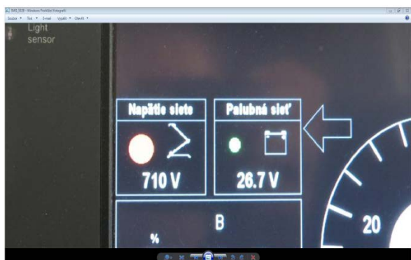
Vysunutý pantograf, batérie dobíjaná.
