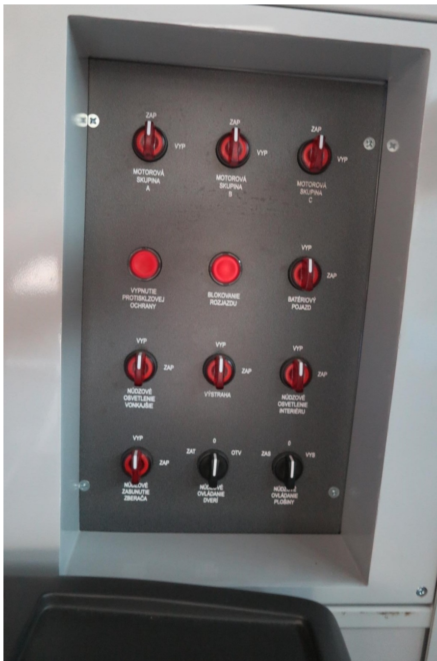
Obr.87 Panel ovládačov za vodičom - núdzový panel
