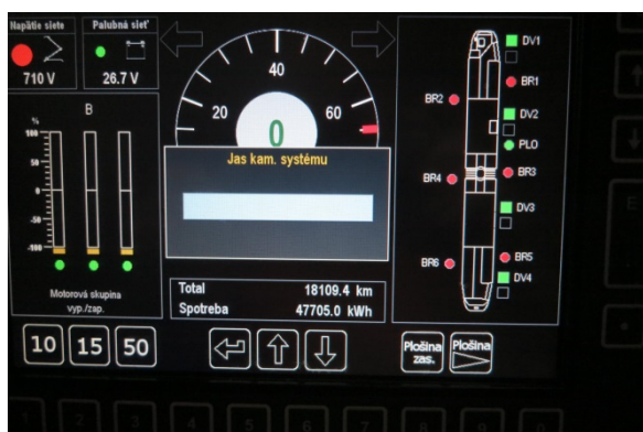
Nastavený maximálny jas displeja kamerového systému
