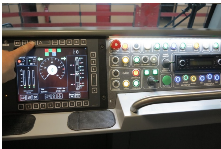
Obr.78 Kontrola signáliek v tlačidlách pultu
