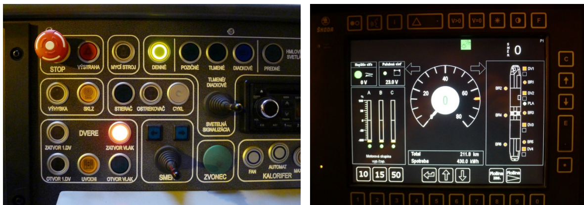
Obr.12 Zapnuté denné svetlá (signalizácia „zatvor vlak“ nemá s dennými svetly nič spoločné)
