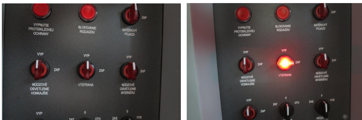
Obr.93 Núdzové výstražné svetlá vozidla; svetla i signálka pri aktivácii blikať s periódou 1 s
