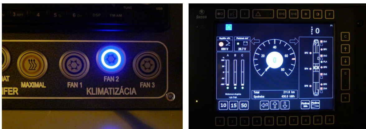
Obr.35 Aktívna stredná (druhá) rýchlosť ventilátora a ikona zapnutej klimatizácie na displeji
