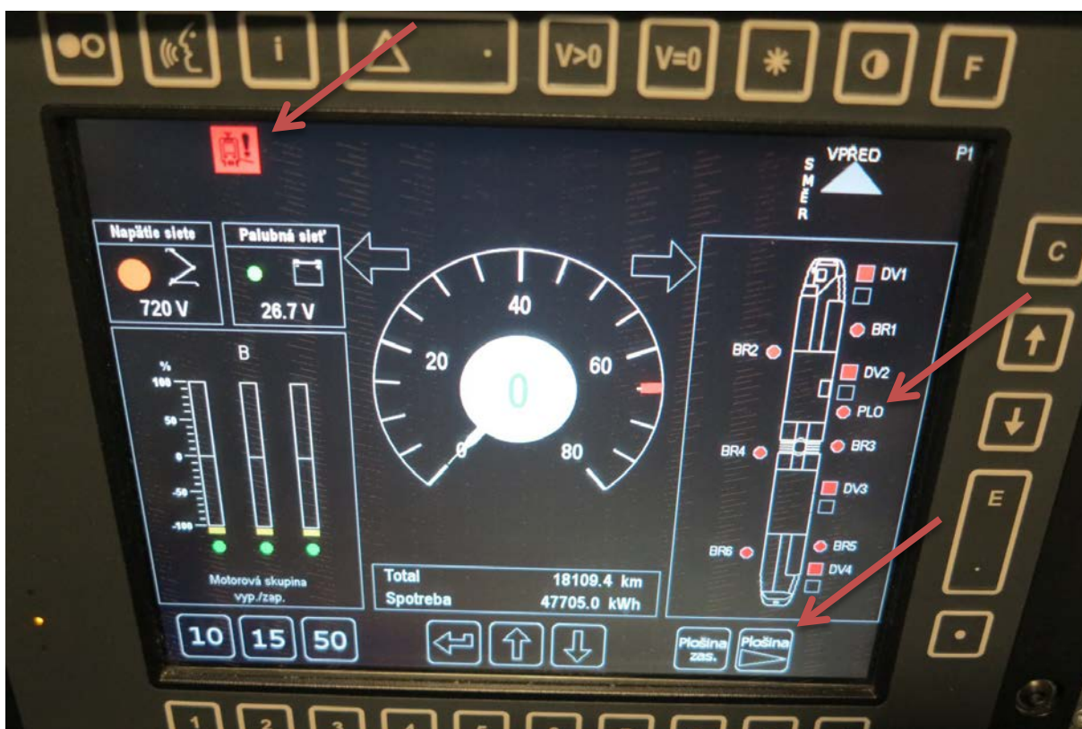
Obr.58 Signalizácia vysunutia plošiny, ovládacie tlačidlá
